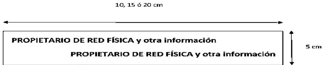
*Ejemplo de adhesivo para etiquetado con dos colores*
