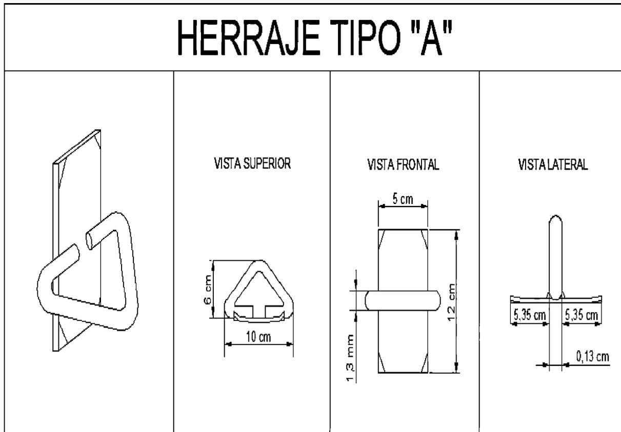
Platina de 3mm de espesor con dimensiones de 12 cm X 5 cm, la cual posee varios dobleces esquineros con el fin de no permitir que la cinta metálica de sujeción se deslice.
